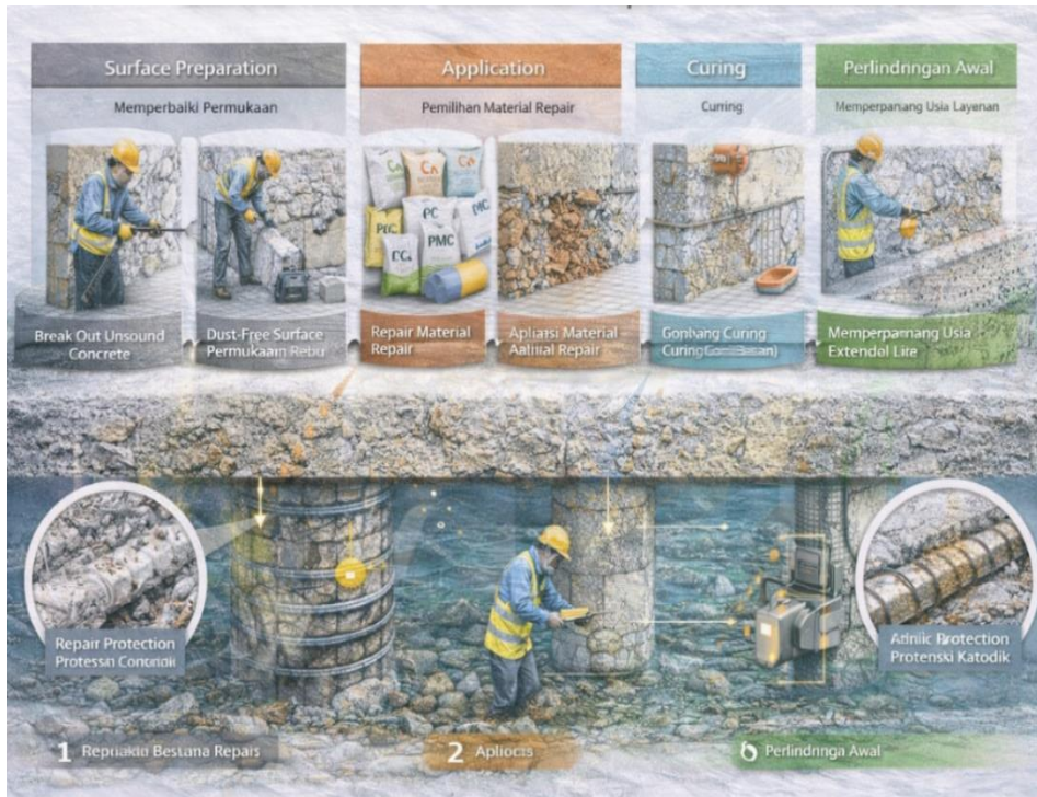
Gambar 11.1. Tahapan pelaksanaan pekerjaan repair beton sebagai suatu sistem terpadu yang mencakup persiapan permukaan, aplikasi material repair, curing, dan perlindungan awal untuk menjamin kinerja jangka panjang (diadaptasi dari EN 1504, 2020; ACI 562, 2021 dan ACI 546R, 2021).
