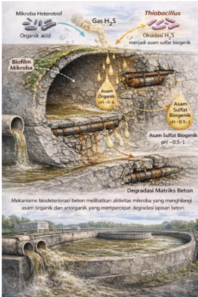
Gambar 2.4. Mekanisme biodeterioration beton akibat aktivitas mikroorganisme yang menghasilkan asam dan mempercepat degradasi matriks beton (diadaptasi dari De Muynck et al. 2020, De Belie et al. 2022, dan Alexander et al.2021).
