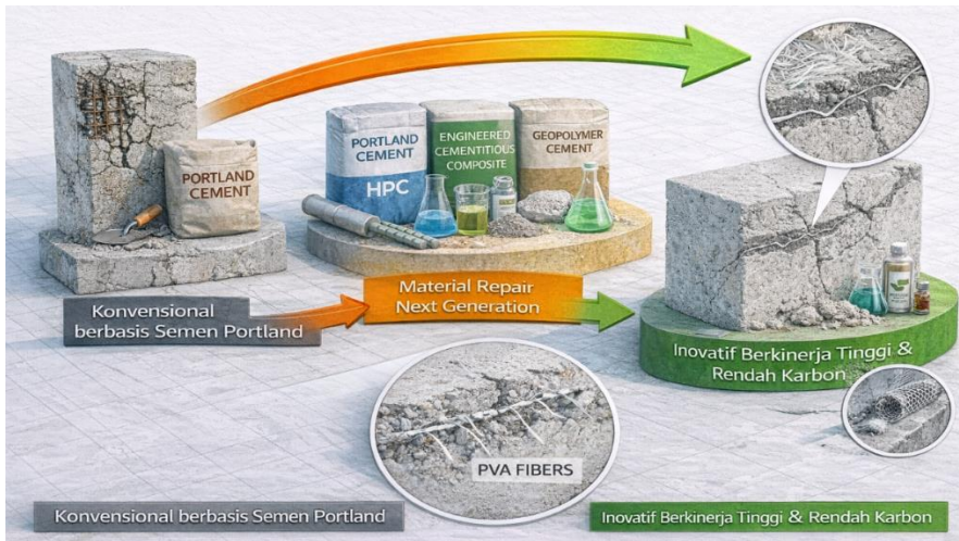
Gambar 6.1. Peta evolusi material repair beton dari material konvensional berbasis semen Portland menuju material inovatif berkinerja tinggi dan rendah karbon (diadaptasi dari Scrivener et al., Pacheco-Torgal et al., Xu et al., dan fib Model Code 2020)
