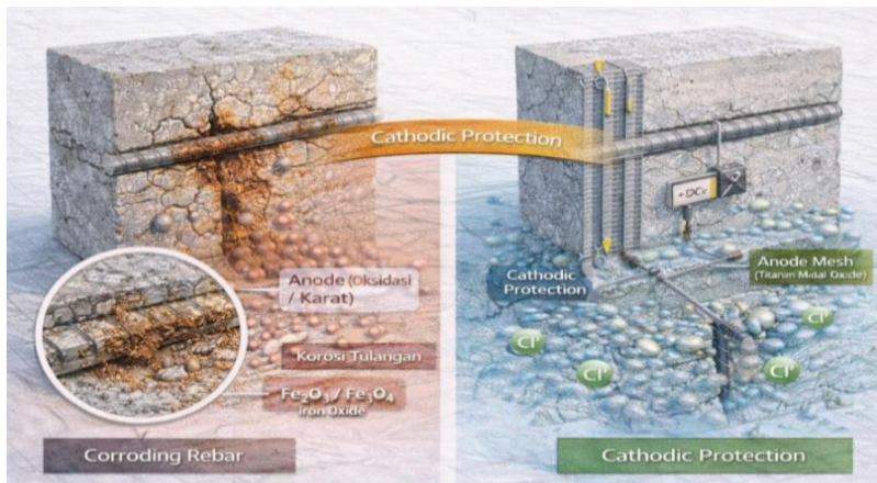
Gambar 8.2. Mekanisme korosi tulangan dalam beton bertulang serta implikasinya terhadap strategi repair beton terkorosi (diadaptasi dari Angst et al. 2023, Andrade & Alonso, 2021, ACI 562, dan fib Model Code 2020).
