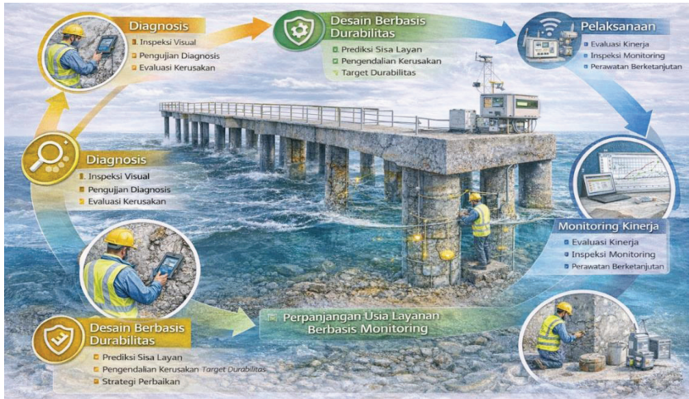
Gambar 12.1. Sintesis best practice teknologi repair beton berbasis integrasi diagnosis, desain berbasis durabilitas, pemilihan material, pelaksanaan, dan monitoring kinerja sepanjang siklus hidup struktur ( diadaptasi dari ACI 562, EN 1504, fib Model Code 2020, dan Stewart ).
