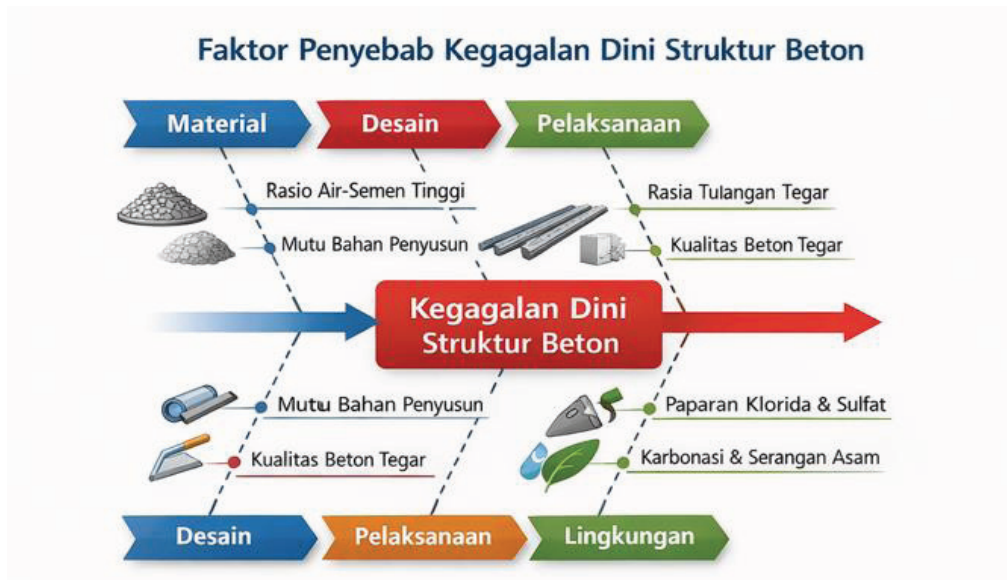
Gambar 1.2. Faktor penyebab kegagalan dini struktur beton yang melibatkan interaksi antara faktor material, desain, pelaksanaan, dan lingkungan (diadaptasi dari Angst et al. 2020, Bentz et al. 2020, Santhanam et al. 2021, dan De Belie et al. 2022).
